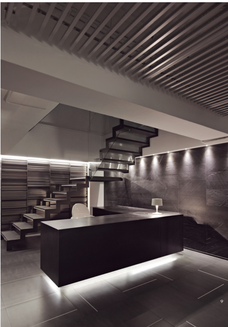
8. 平面圖。9. 將所有在空間中心的量體輕量化，留給牆面表現焦點。10. 穿透的鐵件樓梯將鐵件的剛硬線條更凸顯出來。11. 透過鐵件日積月累的氧化作用，在這道主牆上產生歷史的軌跡。12. 樓梯踏階正面也以金屬修飾石材剖面，金屬感輕薄俐落線條。13. 空間殼體中尋找相對應空間的零件，意即結構材料，例如陽極電鍍鋁料、輕鋼架骨料、L型、扁型生鐵方管，透過設計抽象的互動，重新思考著既有材料的重組可能性。14. 由2樓俯瞰1樓。
